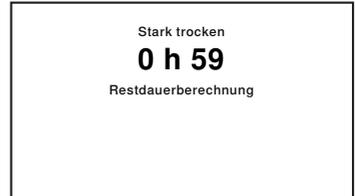
Es ist möglich, dass das Programm länger dauert, als ursprünglich berechnet wurde. In diesem Fall bleibt die Restdauer während des Programmvorgangs stehen. Der Buchstabe «h» blinkt dabei erneut und in der Anzeige steht «Restdauerberechnung».
